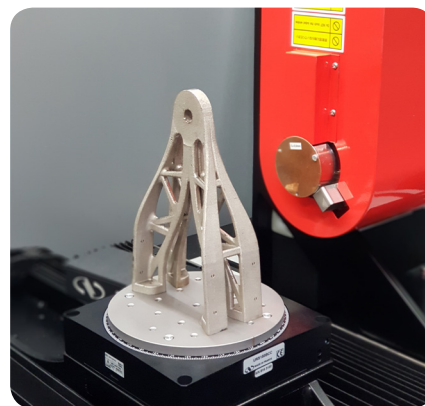
ביצוע סריקת CT תלת-מימדית של חלק תעופתי מודפס מטיטניום שיוצר ע"י מאגד "עתיד"
